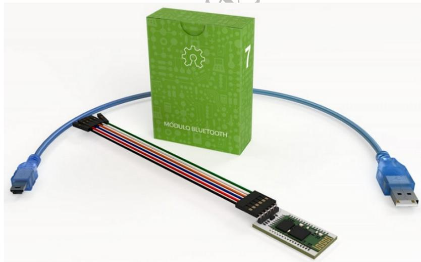
Figura 1.1.2-9 Kit Freaduino: Módulo Bluetooth y USB
